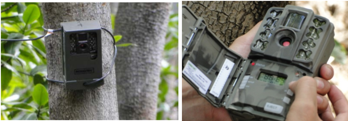
Figura 1.- Cámaras trampa marca Moultrie, con su caja protectora y cables modelo A-30i con sensores al movimiento y calor corporal.
