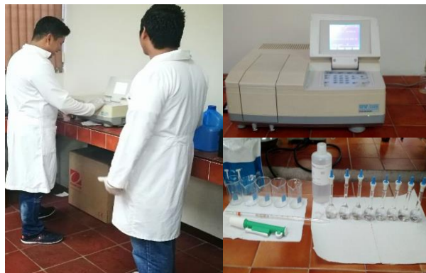
Imagen 9. Procesamiento y análisis de las muestras de agua superficial para la determinación de sulfatos.
