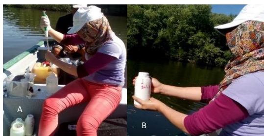
Imagen 7. Recolecta y preparación de las muestras de agua para el análisis de nutrientes, A: colocación de ácido sulfúrico a la muestra de agua superficial para análisis de nitratos, B: obtención de la muestra para traslado al laboratorio.
