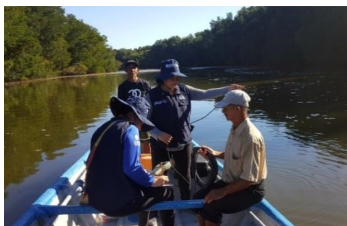
Imagen 6. Registro de parámetros físico químicos con la sonda multiparámetro HANA HI 9829 en la Bahía de La Unión, El Salvador.
